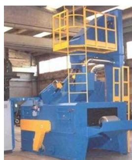
Un operatore carica i pezzi all'entrata del tunnel ed un secondo addetto li raccoglie alla fine del tunnel : risultano completamente granigliati a 360° ed anche esenti da non graditi urti con ammaccature tra di loro. La possibilità di dotare il tunnel di adeguate rastrelliere di raccolta pezzi permette di
