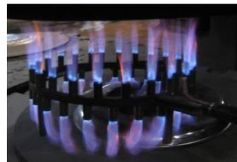
La nostra gamma di soluzioni per il preriscaldamento di superfici metalliche copre le necessità di diverse industrie. **Particolarmente adatti per preriscaldi per saldature.** Impiegano gas ( metano o GPL ) a bassa pressione ( circa 40 millibar ) ed aria compressa.
