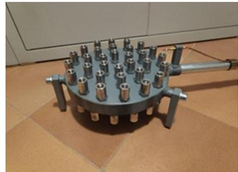
En synthèse nous avons une colonne portante haute environ 1700 mm avec un brûleur série 85 de puissance 60KW/h et aussi 100KW/h. Il emploie gaz à basse pression et air comprimé
