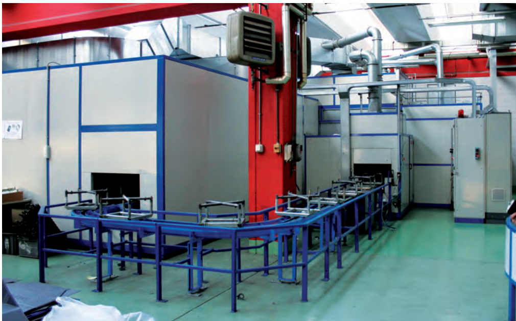
13 - L'impianto di finitura pezzi cromati fisicamente a mezzo di una vernice trasparente resistente agli agenti atmosferici, all'attrito e così via
