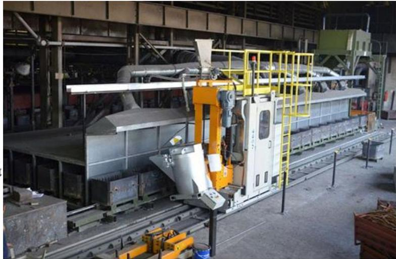
Il sistema è costituito da una struttura dotata di 4 ruote, posizionata su due binari distesi lungo la linea di formatura. Il carro ha un meccanismo di traslazione a cremagliera per muoversi lungo le rotaie accoppiato a una cremagliera temperata.
